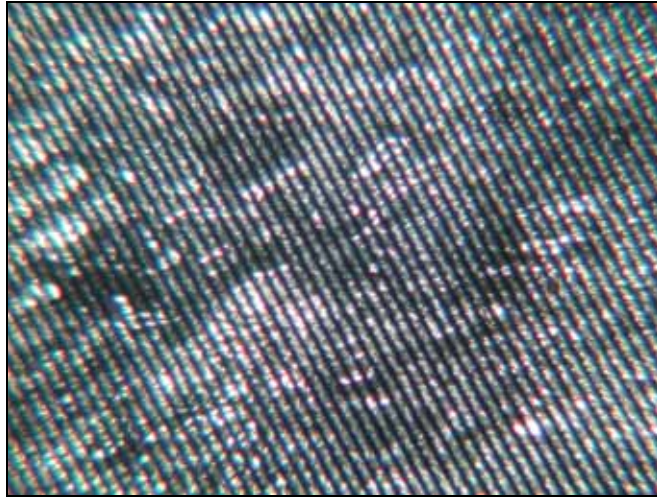
Abb. 12 – Polarisationsmikroskopische Aufnahme des C Hex 8 bei 126,5°C und homeotroper Orientierung zwischen den interdigitierenden Elektroden (schwarze Linien)
