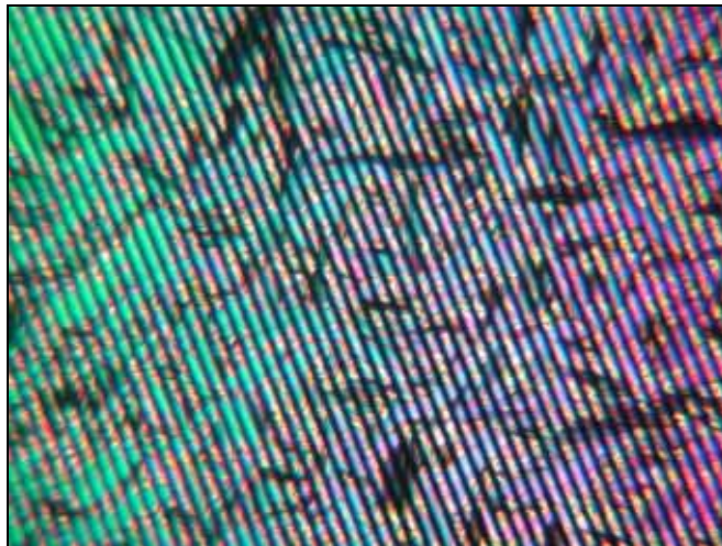
Abb. 13 – Polarisationsmikroskopische Aufnahme des C Hex 8 bei 126,5°C in regelloser Textur zwischen den interdigitierenden Elektroden (schwarze Linien)
